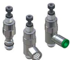
Versione per asta G1/8" con anello con filetto femmina G 1/8" e G 1/4" o raccordo automatico per tubo Ø4, Ø6 e Ø8
