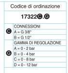
Esempio: 17322A.C Riduttore di pressione con connessioni G 3/8" e gamma di regolazione 0-8 bar con relieving.
